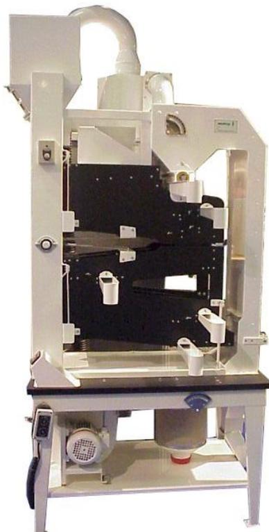
**Использование воздушно-решетного очистителя LA-LSU возможно как в лабораторных, так и в производственных условиях для обработки небольшого количества зерна или семян. Машина обеспечивает точную и тонкую очистку**
